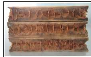
(d) Crushed sandwich with intermittent cracks
