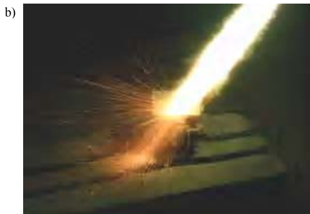
Rys. 1. Widok pistoletu METCO 5P-II firmy Sulzer Metco (a) i sposób natryskiwania powłoki (b)
