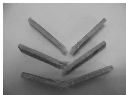
Rys. 7. Próbkilaminatów po próbie udarności: a) bez dodatku recyklatu, b) z dodatkiem 10% wag. recyklatu, c) z dodatkiem 20% wag. recyklatu
