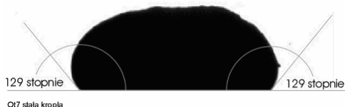
Rys. 3. Zdjęcie ciekłej kropli metalu wykonane w urządzeniu i obró-bione z wykorzystaniem graficznego programu komputerowego COREL DRAW
