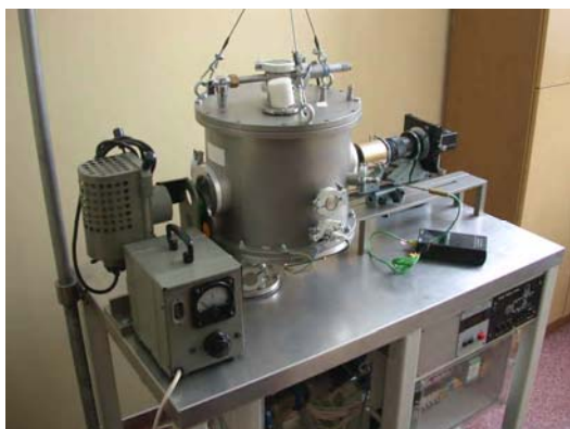
Rys. 2. Aparat do rejestracji konturu kropli ciekłego metalu Fig. 2. The device for recording the shape of a liquid metal drop
