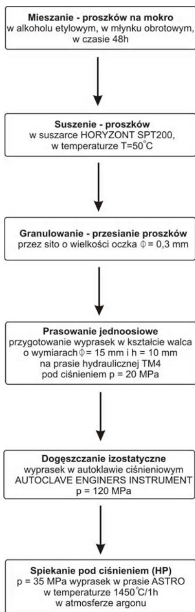
Rys. 3. Schemat procesu wytwarzania materiałów kompozytowych \alpha\text{-Al}_2\text{O}_3 + x\% \text{mas. Si}_3\text{N}_4 ( x = 1, 2, 3, 4, 5 )
