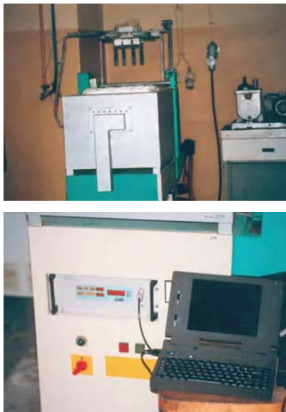
Rys. 1. Stanowisko do badań odporności na szoki cieplne Fig. 1. Set-up for thermal shock resistance tests
