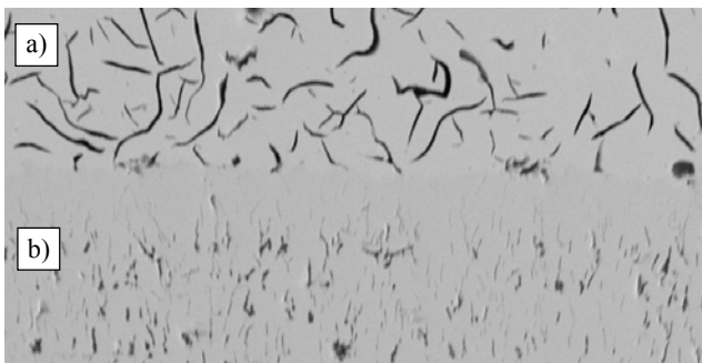
Rys. 1. Pierścień żeliwno-ceramiczny: a) warstwa żeliwa, b) warstwa \text{Cr-Al}_2\text{O}_3
