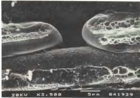
Rys. 2. Przykład porowatości odlewów kompozytowych nasyconych, spowodowanej zbyt wczesnym zakrzepnięciem osnowy nasycającej [6]
