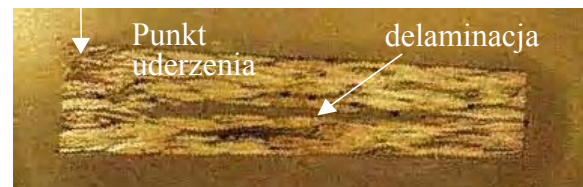
Rys. 3. Przekrój laminatu węglowego zawierającego wewnętrzną delaminację
