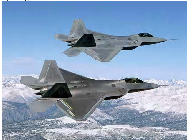
Rys. 6. Samoloty myśliwskie F-22 Raptor floty powietrznej USA w locie. Kompozyty metalowe zastosowano w nich w konstrukcji poszycia (w tym obramowania szkieletowego) i układu sterowania ( Lockheed Martin Aeronautical System, Marietta, Georgia )
