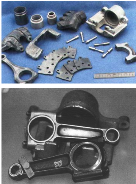
Rys. 14. Kompozytowe tarcze hamulcowe wagonu kolejowego niemieckiego superekspresu ICE-2 (a), kompozytowe odlewy dla przemysłu samochodowego, produkowane przez Lanxide Co. metodą infiltracji quasi-grawitacyjnej ( pressurless infiltration ) (b) oraz aluminiowe kompozytowe korbowody zbrojone włóknem ciągłym (Nextel 610) do silnika samochodu Ferrari (Formuła 1) wykonane metodą gazowej infiltracji ciśnieniowej APIC™ (c). Dotychczas takie korbowody odkuwano ze stali. Korbowód stalowy miał masę 485 g, nowy korbowód kompozytowy - 190 g
