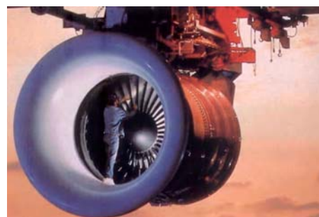
Rys. 7. Struktura kompozytu TiAl6V4/SiC n (włókno ciągłe) (3M) (a), podwozie samolotu z częściami wykonanymi z kompozytów tytanowych ( Mc Donnell Douglas ) (b) oraz silnik samolotowy nowej generacji z łopatkami turbinowymi wykonanymi z kompozytu TiAl6V4/SiC n ( Pratt & Whitney ) (c)
