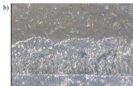
Rys. 7. Morfologia powierzchni warstwy Ni+Al+Ti (a) oraz przekrój poprzeczny warstwy kompozytywnej Ni+Al+Ti ( j = 200 \text{ mA/cm}^2 , 20 \text{ g Ti/dm}^3 , 28 \text{ g Al/dm}^3 ) (b), pow. 70x
