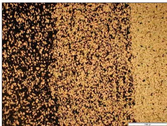
Rys. 3. Mikrostruktura materiału gradientowego \text{Al}_2\text{O}_3\text{-Cr} Fig. 3. Microstructure of \text{Al}_2\text{O}_3\text{-Cr} gradient material
