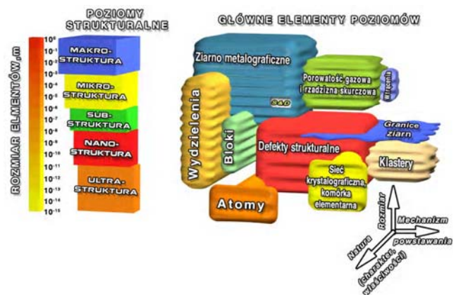
Rys. 2. Schemat struktury metalurgicznej metalu w ujęciu hierarchicznym, opracowany z uwzględnieniem podstawowych pojęć teorii systemów [2]
