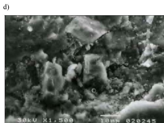
Rys. 3. Obrazy elektronowe powierzchni próbek kompozytu AlSi7Mg-SiC po ścieraniu
