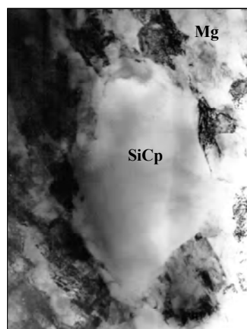
Rys. 4. Mikrostruktura kompozytu Mg-SiCp, TEM, pow. 8800x
