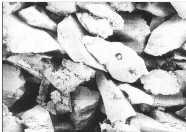
Rys. 2. Ceramiczne tworzywo porowate z elektrokorundu o wielkości ziarna 75 \div 106 \mu\text{m} z dodatkiem 10% obj. \alpha\text{-Al}_2\text{O}_3 jako spoiwa, obraz z elektronowego mikroskopu skaningowego, pow. 200x
