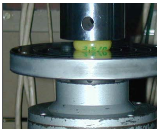
Rys. 4. Próba ściskania elastomeru na maszynie wytrzymałościowej
