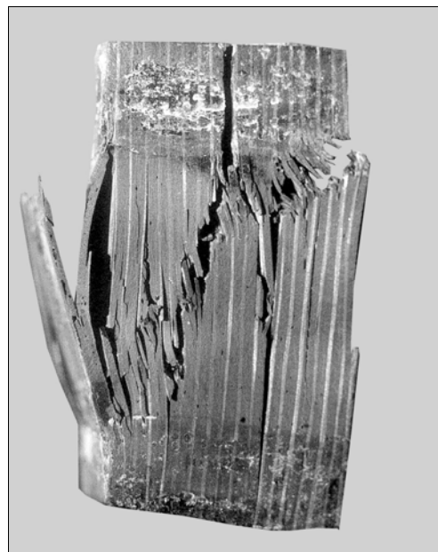
Rys. 1. Widok grubościennej próbki kompozytowej po próbie ścisania. Włókna Toray T 300, żywica Bakelite, rozłożenie włókien 0/±45/90; pow. 1:1 [4]
