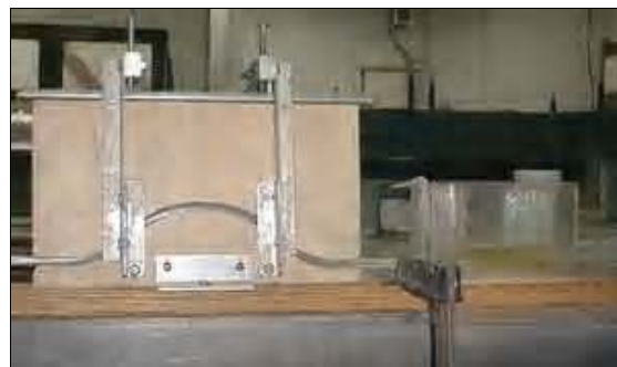
Rys. 4. Sycidło z komorą sycącą o dużym promieniu krzywizny (wariant R3)
