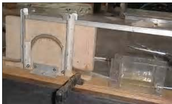
Rys. 3. Sycidło z komorą sycącą o małym promieniu krzywizny (wariant R2)
