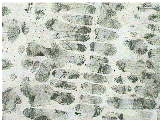
Rys. 1. Mikrostruktura osnowy kompozytu (faza Ni 3 Al) Fig. 1. Microstructure of the composite matrix (Ni 3 Al phase)
