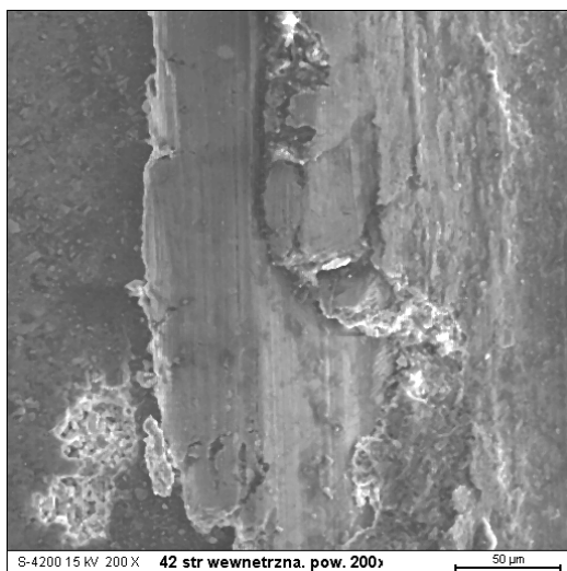
Rys. 9. Widok odkształcenia plastycznego „rozmazania” osnowy powstałego w wyniku tarcia na brzegu toru tarcia, próbka A10, SEM, pow. 200x
