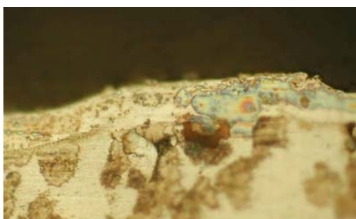
Rys. 7. Struktura próbki materiału gradientowego (Ni-Mo-WC) nakładanego elektroiskrowo na podłoże ze stali St3, pow. 1000x
