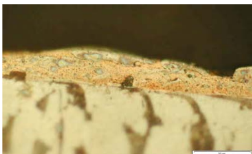
Rys. 6. Struktura próbki materiału gradientowego (Ni-Ti-WC) nakładanego elektroiskrowo na podłoże ze stali St3, pow. 1000x
