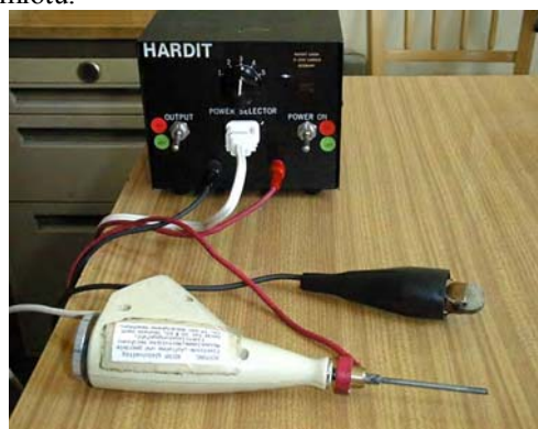
Rys. 2. Stanowisko do nakładania warstw metodą elektroiskrową Fig. 2. The spark hardening system
