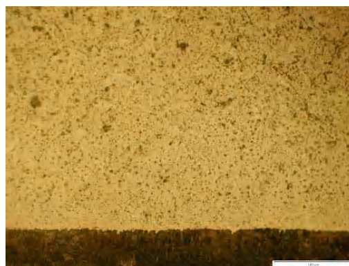
Rys. 2. Mikrostruktura warstwy natryskiwanej płomieniowo Ni,Cr,B,Si+Al 2 O 3 -SiO 2 , pow. 500x
