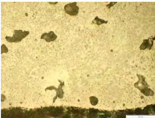
Rys. 5. Mikrostruktura warstwy natrykiwanej płomieniowo Ni,Cr,B,Si+Al 2 O 3 , pow. 200x
