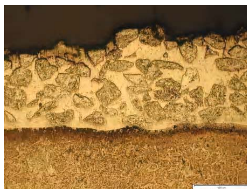
Rys. 3. Mikrostruktura warstwy natryskiwanej płomieniowo proszkiem Eutalloy TungTec 60% WC, 20% Ni, 7% Cr, 6% Fe, 4% Si, pow. 100x
