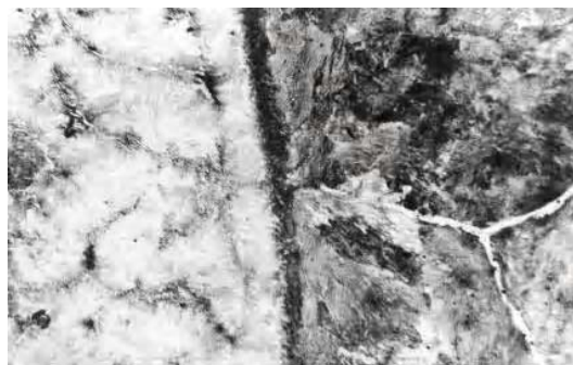
Rys. 4. Stopowa warstwa kompozytowa, strefa przejściowa w kuli \phi 100 mm
