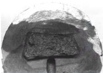
Rys. 3. Przekięta kula z widoczną kompozytową warstwą stopową Fig. 3. Cross-section with visible composite alloy layer
