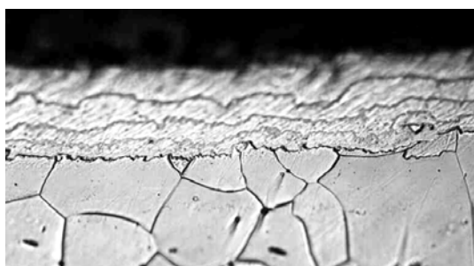
Rys. 3. Powłoka kompozytowa \text{Cu}+\text{Si}_3\text{N}_4 składająca się z czterech warstw, nakładanych przy napięciach: 8, 10, 12 i 14 V. Pow. 1000x
