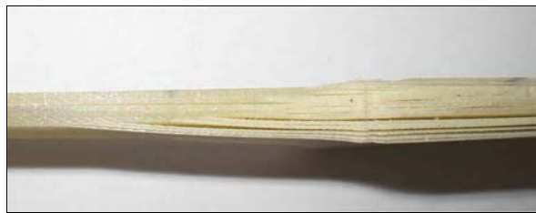
Rys. 7. Duże rozwarstwienia elementu o grubości 4 mm
