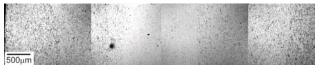
Rys. 11. Gradientowy kompozyt Ti 3 Al+x%TiB 2 spiekany pod ciśnieniem Fig. 11. Gradient Ti 3 Al+x%TiB 2 composite sintered under pressure
