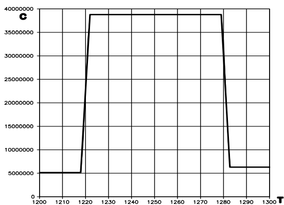
Rys. 4. Zastępcza pojemność cieplna dla materiału warstwy kompozytującej
