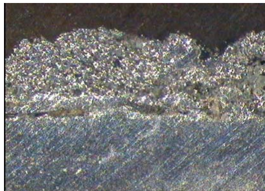
Rys. 2. Zgląd poprzeczny warstwy kompozytywnej Ni45,90%-Mo17,80%+V36,30% ( j = 250 \text{ mA/cm}^2 ) (pow. 200x)
