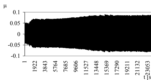
Rys. 5. Zmiana współczynnika tarcia w funkcji czasu. Próbką IV
