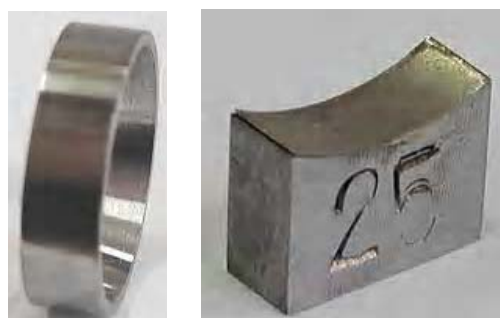
Rys. 8. Wygląd próbki V i przeciwpróbki po badaniach w oleju
