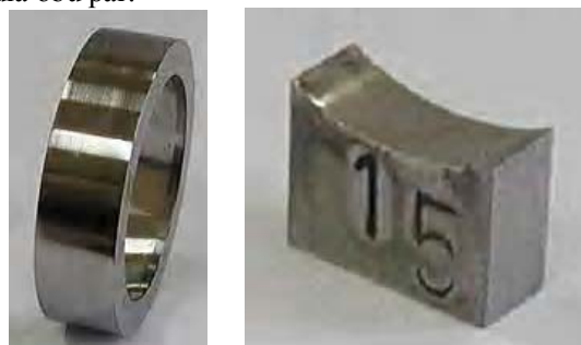
Rys. 7. Wygląd próbki I i przeciwpróbki po badaniach w oleju
