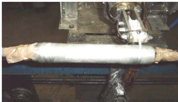
Rys. 3. Nawinięcie warstwy rowingu szklanego
