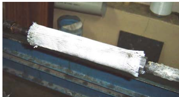
Rys. 2. Nasunięcie na rdzeń koszulki plecionej
