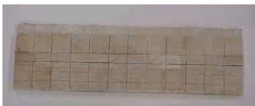
Rys. 2. Przykład rdzenia wykonanego z balsy [4]
