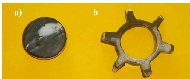
Rys. 8. Odkuwka modelowa wykonana z plasteliny: a) wsad, b) odkuwka
