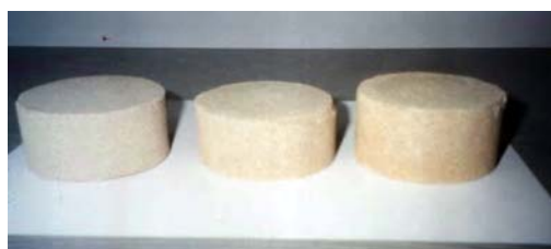
Rys. 5. Preformy wykonane z mikrosfer popiołu lotnego (średnica 80 mm, wysokość 40÷50 mm)
