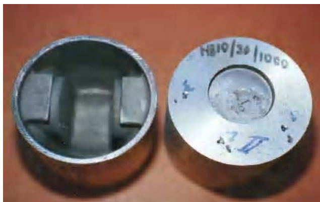
Rys. 1. Tłoki wykonane z kompozytu ALFA metodą prasowania w stanie ciekłym
