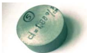
Rys. 6. Piana syntaktyczna AK12/50% obj. mikrosfer o gęstości 1,88 g/cm 3 (po skórowaniu)
