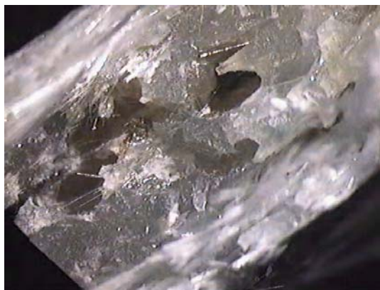
Rys. 9. Przełom próbki po udarności (pow. 20x)
