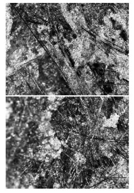
Fig. 4. PMMA/carbon composite fibre surface Rys. 4. Powierzchnia kompozytu PMMA/włókno węglowe
