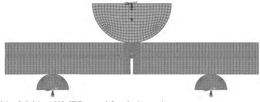
Fig. 5. General view of calculation model for SENB type sample for crack resistance testing Rys. 5. Widok modelu obliczeniowego próbki do badań odporności na pękanie SENB
