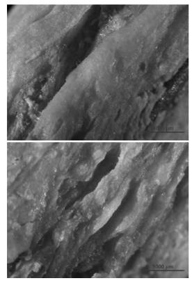
Fig. 3. Cracking of cement mass Rys. 3. Pęknięcia masy cementowej
