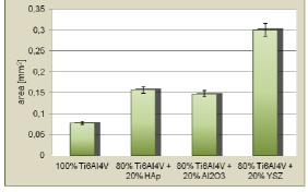
Fig. 6. Wear on surface of individual samples Rys. 6. Zużycie powierzchni poszczególnych próbek
