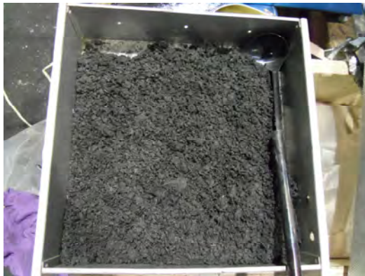
Fig. 1. View of 3D granules of short carbon fibers after heat treatment Rys. 1. Widok granul 3D z włókien krótkich po obróbce cieplnej
