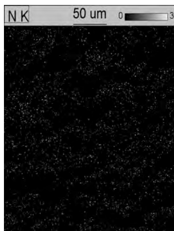
Fig. 2. Distribution of nitrogen atoms in plate middle layer Rys. 2. Rozkład atomów azotu w warstwie środkowej płyty
