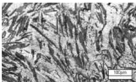
Rys. 5. Mikrostruktura kompozytu CuPb30+20% C gr Fig. 5. Microstructure of CuPb30+20% C gr composite
