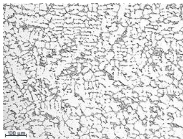
Rys. 5. Mikrostruktura stopu AlSi10Mg, odlew grawitacyjny
