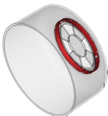
Rys. 5. Strefa ponownego uplastycznienia otryskiwanej membrany Fig. 5. Re-melt zone of overmolded membrane
