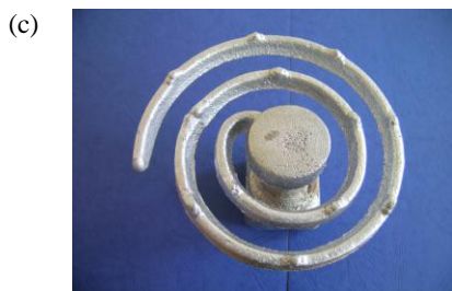
Rys. 1. Krzywe krzepnięcia (a) i próba lejućności (b) stopu bazowego 226D, (c) stopu po modyfikacji 226D+1%Mg+0,03% Sr
