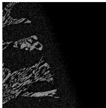
Rys. 10. Powierzchniowy rozkład chromu dla struktury z rysunku 9
