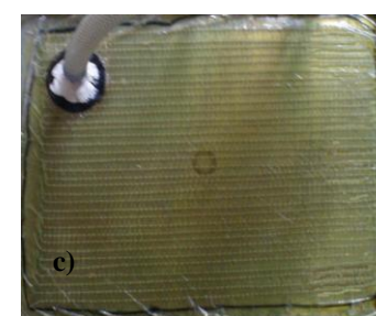
Rys. 2. Etapy rozptyłu żywicy podczas procesu RFI - preforma 10 warstw włókna szklanego: a) i b) żywica przemieszcza się wzdłuż krawędzi preformy, c) po całkowitym nasyceniu
