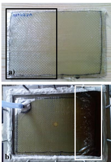
Rys. 5. Przykłady problemów związanych z technologią RFI: a) laminat z osnową „wysaną” podczas procesu na skutek nieszczelności pomiędzy folią i formą, b) nadmiar żywicy powstały na skutek niewłaściwego rozprowadzenia żywicy lub nieszczelności formy w czasie nasycania
