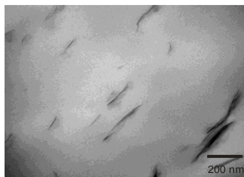
Rys. 6. Mikrografie TEM nanokompozytu PP/10% PB X5104/2,5 Nanofil 5
