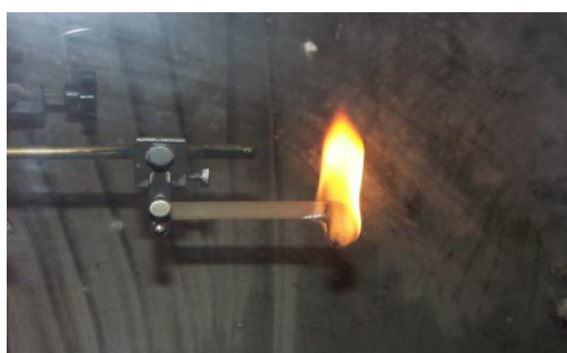
Rys. 5. Próba palności poziomej nanokompozytu PP/5% wag. Nanofil 5/10% wag. Polybond X5104
