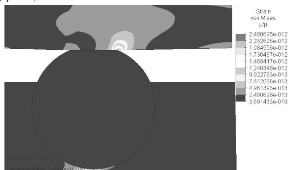
Rys. 7. Rozkład odkształceń w styku żeliwa cząstka FZ bez sił tarcia (a) i z siłami tarcia (b)
