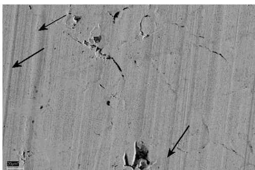
Rys. 4. Powierzchnia żeliwa po współpracy z kompozytem (ślady zużycia ściernego przez cząstki Al_2O_3 w postaci wzdłużnych rys zaznaczonych strzałkami) Fig. 4. Cast iron surface after sliding against composite (traces of abrasive wear caused by Al_2O_3 particles as long scratches signed with arrows)
