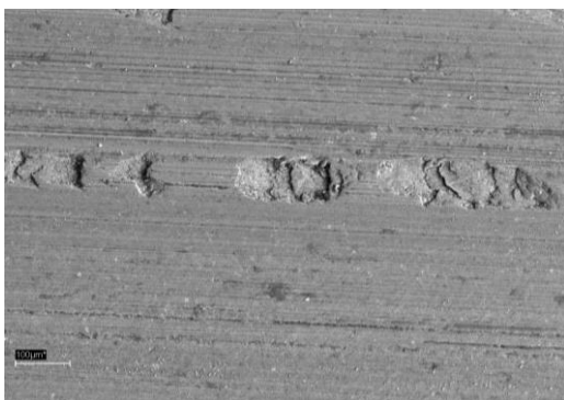
Rys. 3. Powierzchnia kompozytu po współpracy ślizgowej z żeliwem (zniszczenie spowodowane usunięciem cząstką FZ) Fig. 3. Composite surface after sliding against cast iron (damages caused by removed RP)
