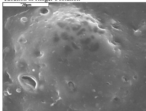
Rys. 32. Mikrofotografia SEM próbki PGLA+HA po 6 tygodniach inkubacji w płynie Ringera
