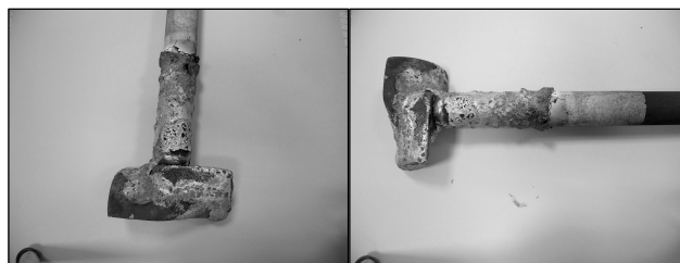
Rys. 2. Widok powierzchni zużytego mieszadła grafitowego stosowanego do wytwarzania zawiesin kompozytowych w Katedrze Stopów Metali i Kompozytów Politechniki Śląskiej, po 10 cyklach
