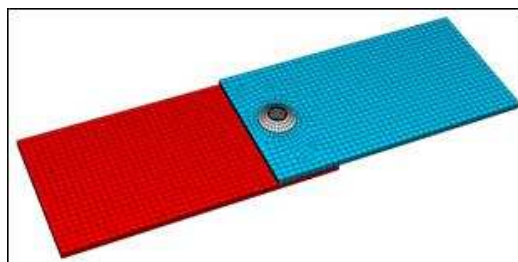
Rys. 6. Model 3D zakładkowego połączenia nitowego płyt kompozytowej i aluminiowej
